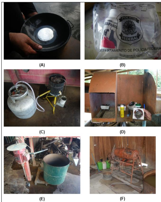
**Fig. 13.** Mercúrio e instrumentos utilizados na amalgamação: (A) Resíduo de mercúrio; (B) Frasco de mercúrio; (C) Retorta; (D) Capela e tigelas de fundição; (E) Tambor de amalgamação com agitador elétrico pendurado à esquerda; (F) Amalgamadeira (elaborado por Wladimir Hermínio de Almeida).
