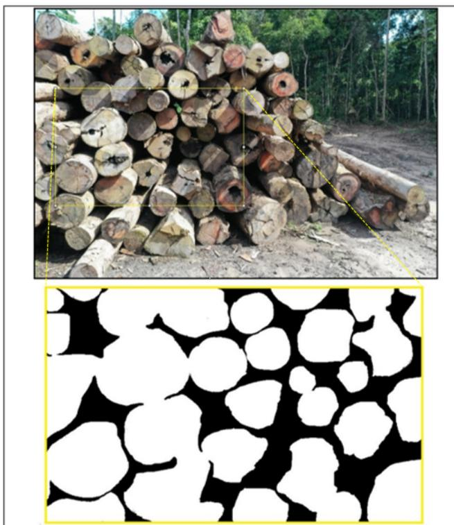
**Fig. 11.** Pilha de toras medida por fotogrametria digital por meio de drone (Petersen, 2021).
