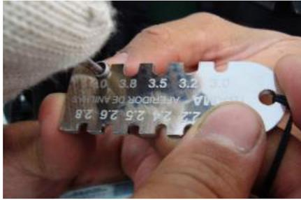
**Fig. 7.** A anilha apenas se encaixa na reentrância referente ao diâmetro interno de 4 mm. Como o diâmetro interno da anilha de um *Saltator similis* é de 3,5 mm configura-se sua adulteração (alargamento) visando possibilitar o anilhamento de espécime adulto.
