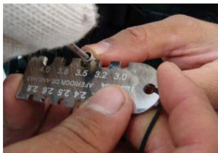
**Fig. 6.** Utilizando um aferidor de anilhas, equipe do IBAMA confere anilha de um trinca-ferro (*Saltator similis*) cujo diâmetro interno é de 3,5 mm. O aferidor verifica se o diâmetro externo é compatível com o interno (3,5 mm). Observa-se que a anilha não entrou na reentrância do aferidor referente a anilha 3,5.
