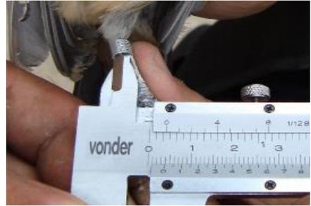
**Fig. 8.** A avaliação do diâmetro interno com o paquímetro demonstra um diâmetro mínimo de 3,95 mm quando deveria ser de 3,5 mm. Esta diferença de 0,45mm foi suficiente para o anilhamento de animal adulto. Agregando-se valor, “lavando-se” animal oriundo do tráfico.
